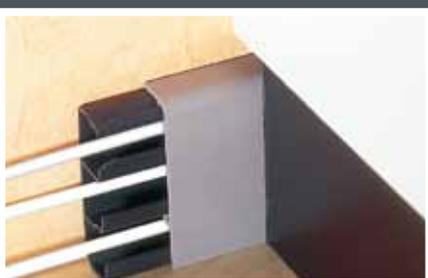
← Der 8 cm hohe Stahlsockel ist gegenüber der hinteren Korpuskante zurückgesetzt, damit der Schrank bündig an die Wand gestellt werden kann, ohne dass die Wandabschlussleiste entfernt werden muss.
