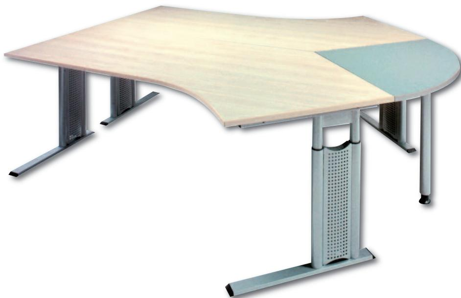
Die Basis dieser Arbeitstische zum Anheben oder Absenken der Tischhöhe bilden zwei ineinander gleitende Rundrohre je Gestellseite, geführt in Kunststoffmuffen. Die Rundrohre stehen auf einer Kufe, die jeweils zwei Stellschrauben zum Ausgleich von Bodenunebenheiten trägt. Zwischen den Rundrohren sind zwei seitliche Blenden aus gebogenem Lochblech montiert. Dazwischen ist genügend Platz für die Elektrifizierung der Tische. Für die Kabel und Netzgeräte befindet
